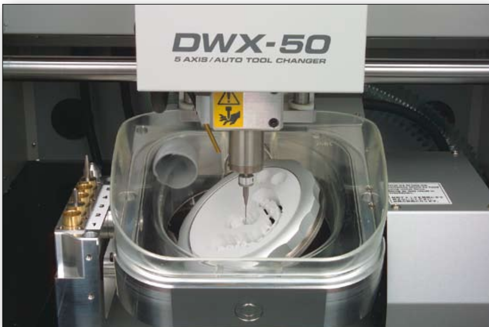
Afbeelding 3. Frezen van kronen in zirkonium (Roland DG).
